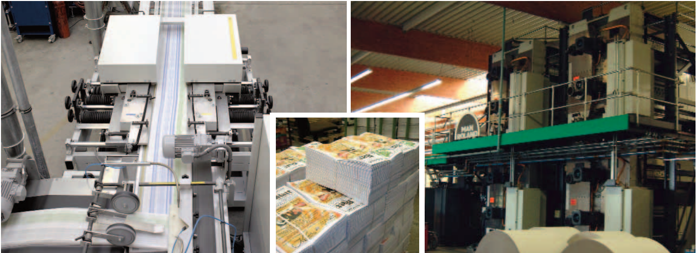
Mit der MAN Roland Uniset (re.) ist RMP in Troisdorf nach eigener Aussage »ein Quantensprung in Qualität und Ökonomie gelungen«. Die Weiterverarbeitung der inline rückengeleimten Zeitungen erfolgt über Rotationsschneider (li.).
